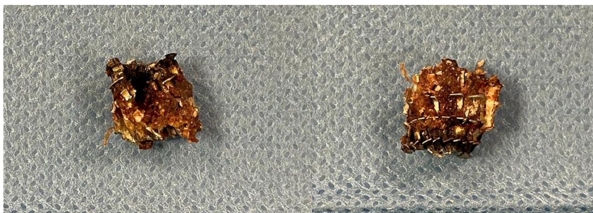
Tornillo pediculares cortados a la mitad y abierto el alma en la que se evidencia crecimiento óseo.
